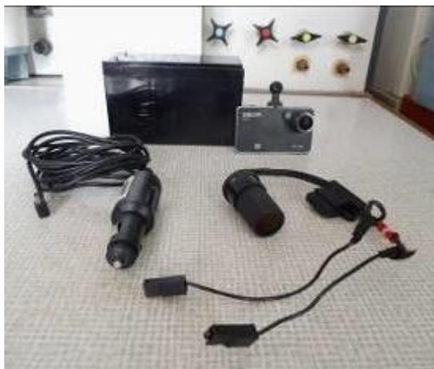
**Рис. 2.** Автомобильный видеорегиратор с батареей и комплектом соединительных проводов.
